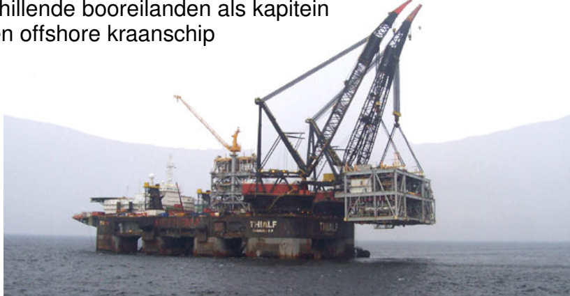
Het grootste kraanschip ter wereld de Heerema Thialf (hijscapaciteit 14.200 ton)
